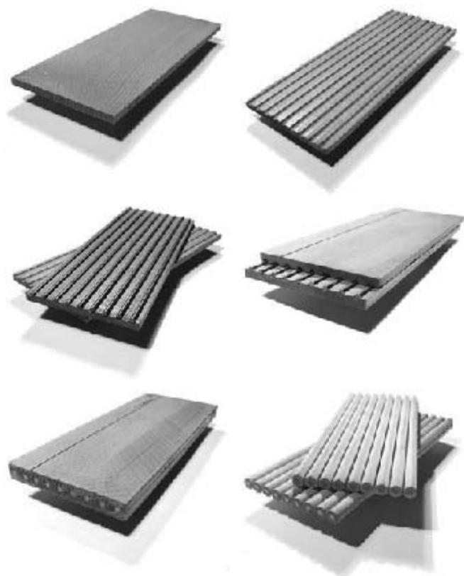
Fig. 4. Esquema das fases da fabricação de lápis
