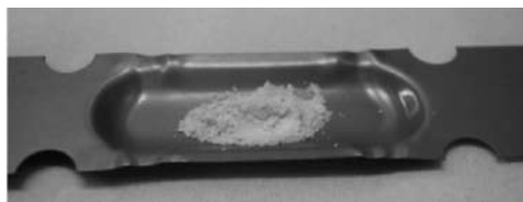
Fig. 3. Cadinho de tungstênio com fluoreto de lítio e alumínio.
