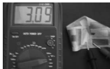
Fig. 20. Flexibilidade da bateria utilizada no fecho do canal do transístor de papel.
