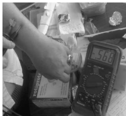
Fig. 13. Fotografia da medição do valor de tensão de um dispositivo, utilizando a pele como contacto.
