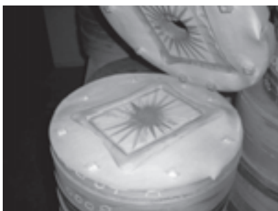
Fig. 1. Molde de silicone usado no processo de fundição por centrifugação.
