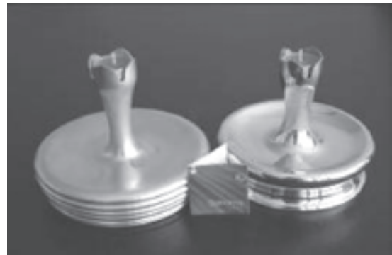
Fig. 9. Protótipo em estereolitografia (esquerda) e produto final em estanho (direita).
