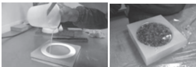
Fig. 11. Vazamento de resina em molde de silicone obtido a partir de um modelo de PR.
